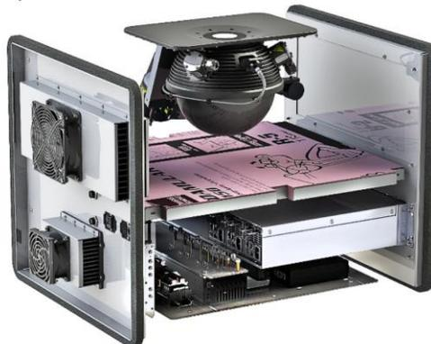
系统下半部分的电子机架包含三个灯电源 (每个 QTH 灯一个)。系统下半部分还包含: 系统的 Cube PC (内置 Labsphere HELIOSense 控制软件), 一个热电偶接口控制单元, 一个 USB 集线器, 滤光轮控制器和所有支持的电源。还包括: 一台带有 HELIOSense 的远程笔记本电脑看, 一个定制的 LAN 软件接口和一个以太网路由器, 以便同时远程控制多个系统。
