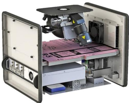
密封的漫反射窗口位于积分球开口端正上方的系统外壳顶部, 以保护其免受室外天气的影响。积分球光源包括风扇冷却的 HES-150 (150W)、带有手动可变光阑 (VAM) 的外部 QTH 灯, 该灯通过 5 个位置、2 英寸滤光轮 (HFW-5-2) 进入积分球, 输出滤光后的颜色和波长。
