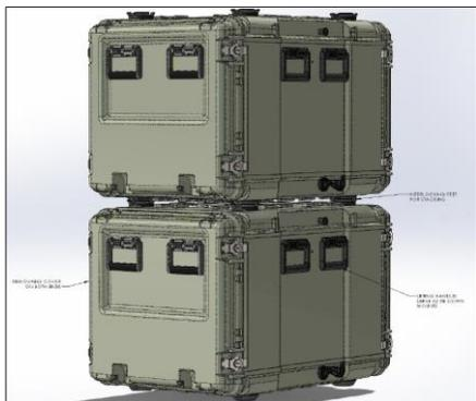
系统套箱分为两半; 8inch 积分球与灯、VA 和探测器装置在上半部分, 配套的电子元件机架安装在下半部分。隔热天花板/地板将两部分隔开。两部分都包含风扇冷却散热器和温度监控点, 用于过温保护 (在发生热损坏之前关闭系统)
