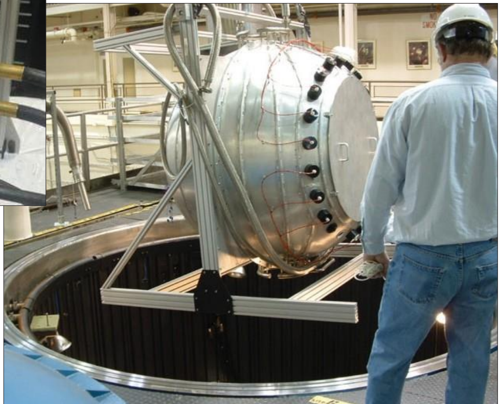
真空用1.5m LN2制冷式、8KW绝对均匀光源 正降入NASA的3m热真空箱体中
