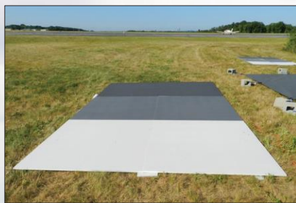
机载校准用大尺寸 Permaflect®漫反射目标板
