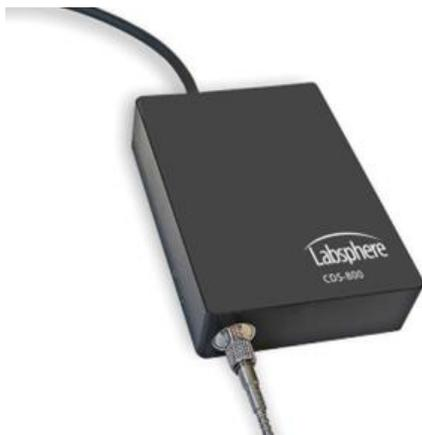
该光谱仪为一款高性价比的光谱仪，采用 Hamamatsu 2048 通道 CCD 探测器。适用于常规所有的光电色测量。
