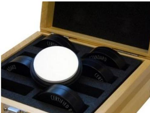
Labsphere Inc.制造的 Spectralon 漫反射板，提供 250nm-2500nm 范围 1nm 间隔分漫反射率数据。极其细腻，因为灰尘等污染可以采用特殊手法水洗。反射率溯源至 NiST。
