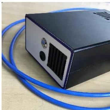
大功率光纤准直卤钨灯，提供 350nm-1800nm 的宽光谱入射光源，3° 的准直光。
